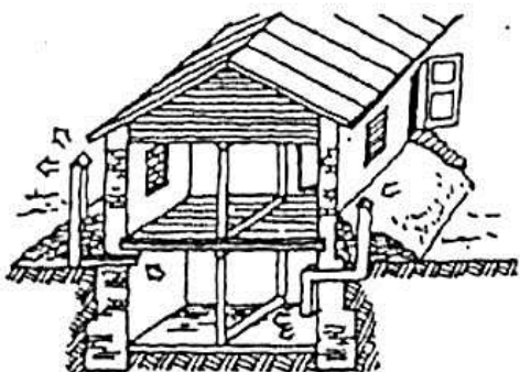
Противорадиационное укрытие в подвале дома
